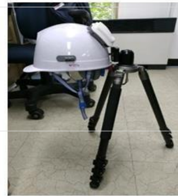
CCTV 설치가 어려운 지역에 활용되는 거치형 IoT 헬멧
