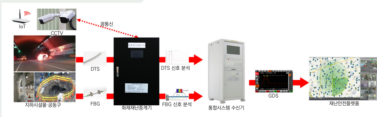
그림 8. 광섬유 센서를 이용한 화재감지
