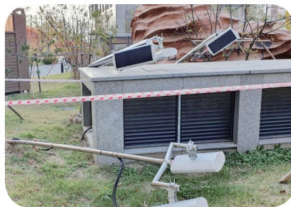
옥외 이동통신 안테나 강도 계산 부족으로 강풍에 의한 전도 및 파손 발생
